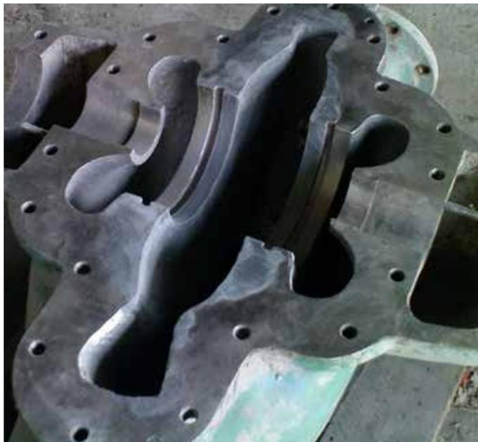
Belzona 1121 (Super XL- Metal) é um compósito de epóxi 100% sólido, de cura a frio, reforçado com liga de aço-silício. Ele é ideal para climas quentes e grandes áreas, em que é necessária uma vida ativa prolongada.
