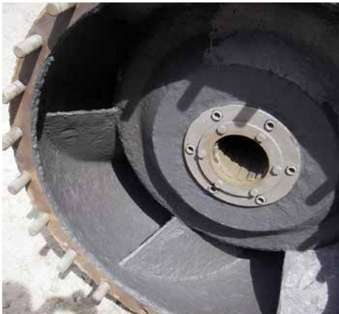
Belzona 1311 (Ceramic R-Metal) é um compósito para reparos desenvolvido para recuperar e proteger metais contra os efeitos da erosão e da corrosão.
