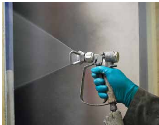
Belzona 1381 pode ser pulverizado com desgaste desprezível do bico do pulverizador
