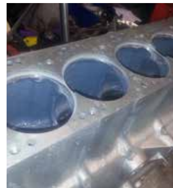
Bloco de motor revestido
