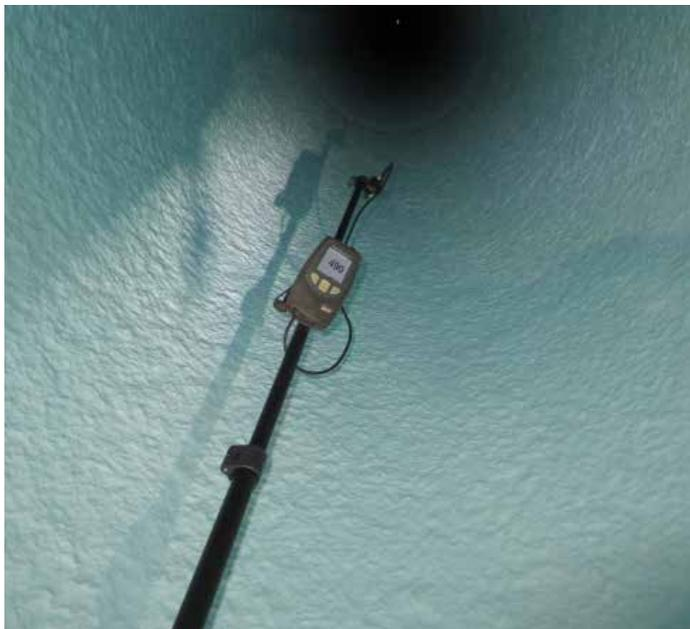
Belzona 1523 oferece resistência duradoura contra produtos químicos e corrosão a equipamentos que operam sob imersão contínua, em temperaturas de até 140°C. Este revestimento, aplicado por pulverização, tem uma janela entre demãos de 24 horas que permite a conclusão de grandes projetos de forma eficaz e rápida, reduzindo drasticamente o tempo de inatividade.
