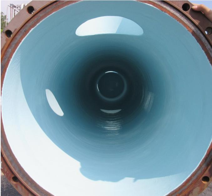
Belzona 1593 é um revestimento de alta temperatura adequado para equipamentos que operam sob imersão contínua em sistemas aquosos e de hidrocarbonetos em temperaturas de até 160°C. Ele oferece proteção excelente e duradoura contra corrosão e resiste a uma grande variedade de produtos químicos.
