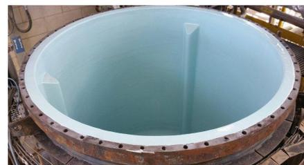
As cores claras de Belzona 1593 permitem fácil inspeção visual em vasos.
