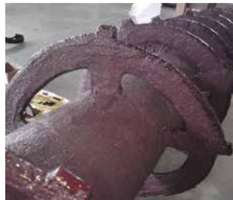
Rosca auger revestido com Belzona 1811
