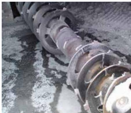
Parafuso auger antes do revestimento
