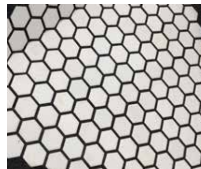
Rejunte de telhas de alumina
