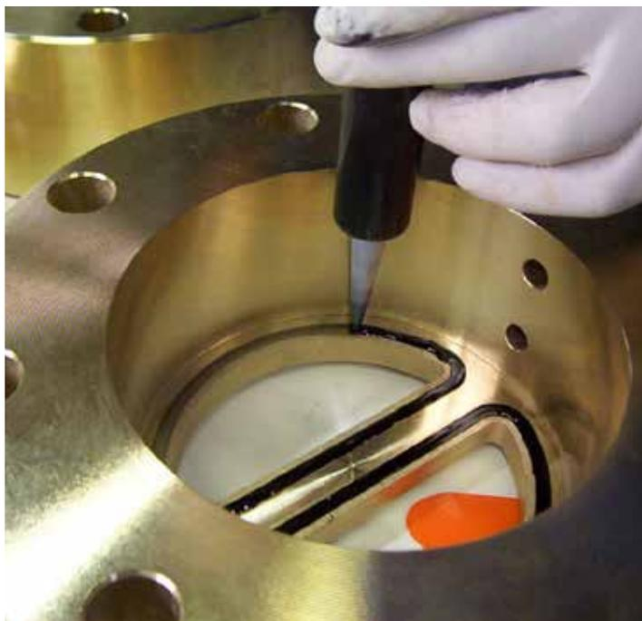
Belzona 2131 (D&A Hi-Coat Elastomer) é uma resina poliuretânica bicomponente, desenvolvida para revestimento de superfícies metálicas e de borracha, bem como para a moldagem de novos componentes de borracha.
