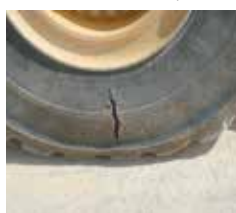
Rachadura e fenda reparadas
