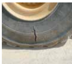
Rachadura e fenda reparadas
