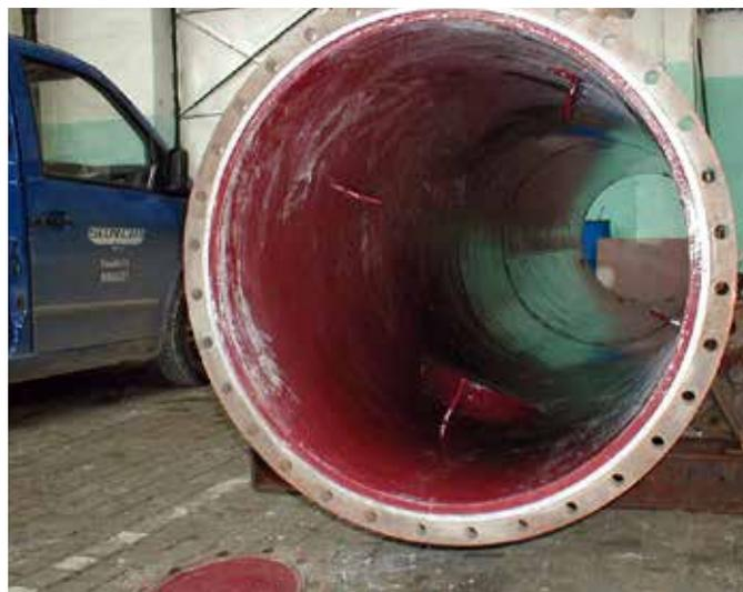
Proteção adicional aplicada a uma torre de reação química
