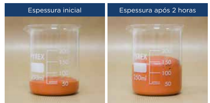
Expansão da espuma Belzona 5871 após 2 horas
