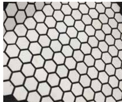
Rejunte de telhas de alumina
